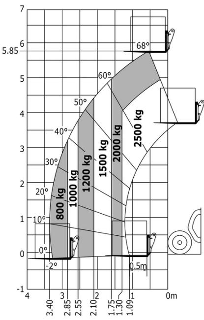
Machine sur pneus avec fourches Impérial
